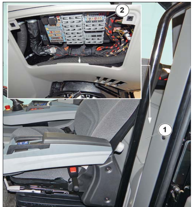
Afbeelding 214: Zekeringen en relais in cabine
